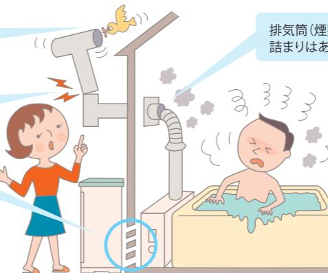
いずれも放置しておくと、ガス機器が正常に燃焼しない、あるいは排気が室内に入流するなどして、一酸化炭素中毒の原因となるおそれがあります。
