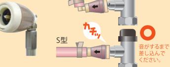
ガス栓への取り付け方
