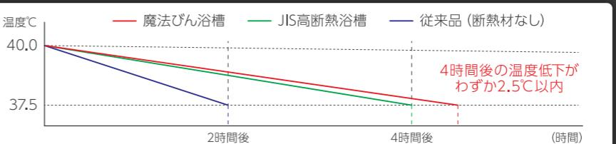
※TOTOの魔法びん浴槽はJIS高断熱浴槽の基準を満たしています。JIS基準：ユニットバス周囲温度10°C、浴槽湯量は深さ70%、断熱ふろふたを閉めたままの状態で4時間後の温度低下が2.5°C以下。※測定条件：楽湯付き（停止状態）
