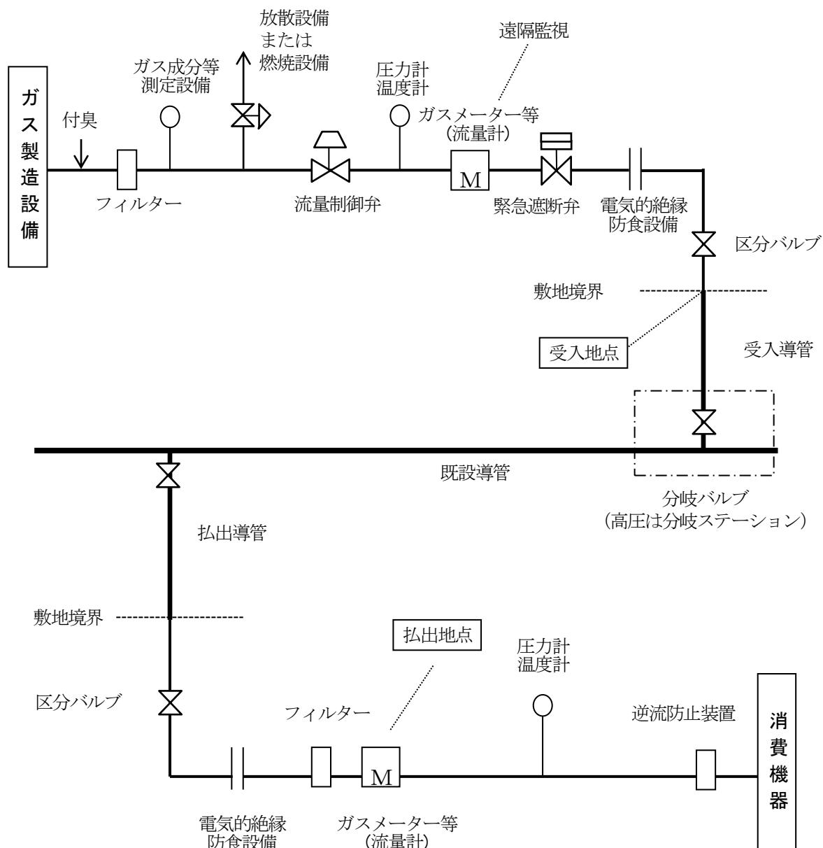
注: 上図は概念図として参考に図示したものです。ガス製造形態や受入および派出地点の位置等による差異が大きいため、詳細は個別に協議させていただきます。
